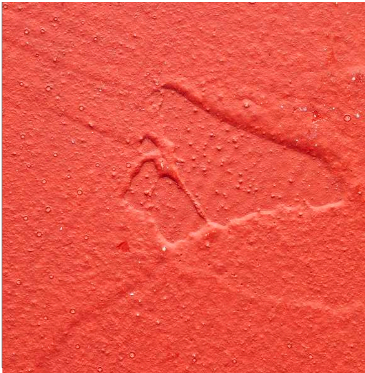
FOTO CAMPIONE MALTA LACCATA / PHOTO SAMPLE LACQUERED MORTAR
